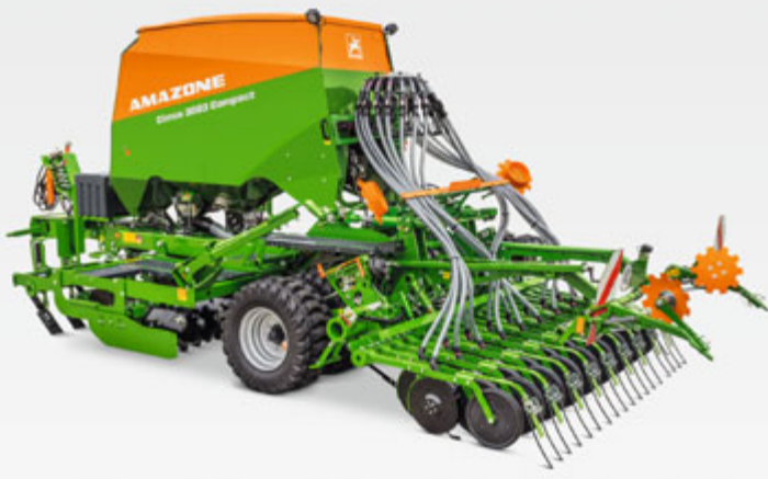
Cirrus 3003 Compact з TwinTeC + дводисковим сошником
