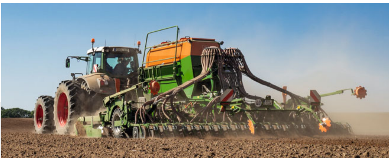
Використання ножового котка для формування дрібного посівного ложа під час сівби пшениці
