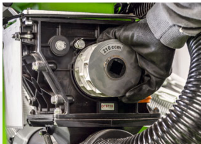
Проста заміна дозуючих котушок
