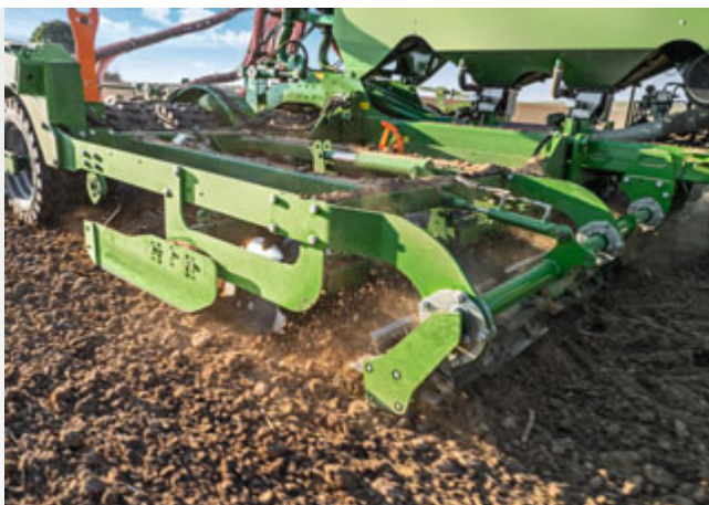
Ножовий коток як агресивний додатковий інструмент для Cirrus 6003-2
